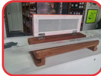
*Las mesas para el sector gráfico tendrán un sistema de prensas que permitirán elevar el marco para cambiar el material a imprimir y volver luego a la misma posición si perder registro, ofrecemos la mesa de impresión en diferentes formatos y las prensas por separado*
