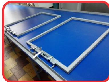
*Para el sector textil es necesario contar con un sistema de registro ligado a cada marco, contamos con sistemas de impresión de un solo puesto o la opción de mesas de impresión lineales*
